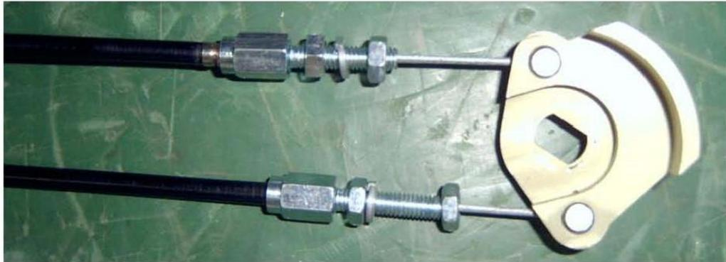
图 19 将新的拉线组件装入凸轮中
