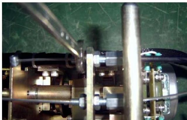
图 11 松开拉线组件上靠近拉线座的螺母
