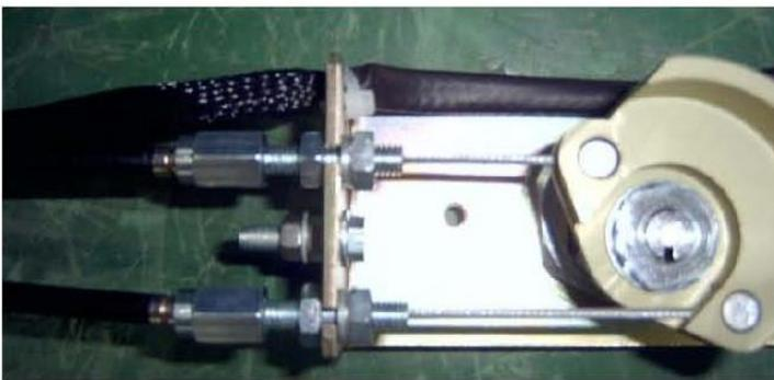
图 25 拧紧拉线组件上位于联锁支板两侧的螺母
