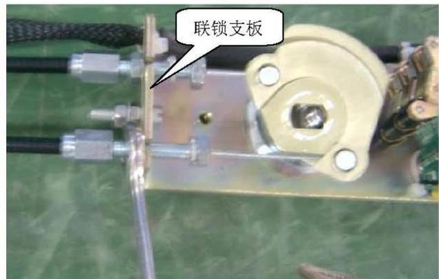
图 6 拧松联锁支板另一侧的拉线组件中的螺母
