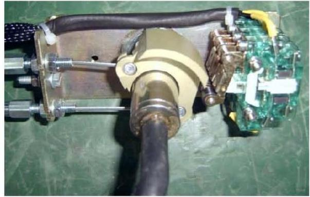
图 2 拆下锁组件上的小螺母及垫圈
