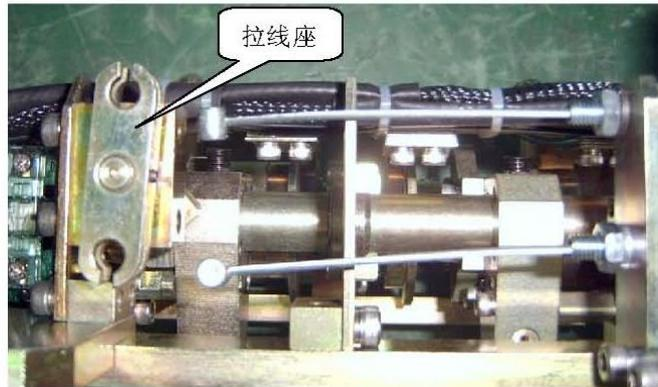
图 10 将拉线组件从拉线座中取下
