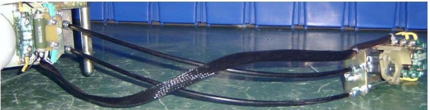
图 20 已装在司控器主体中的拉线组件在侧板锁组件中(联锁凸轮上)的正确安装位置
