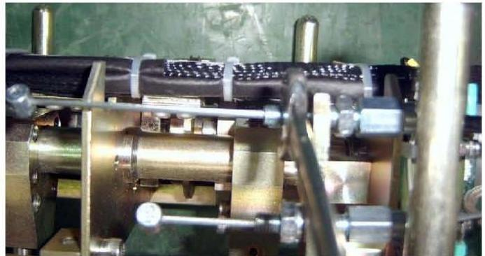
图 16 拧紧拉线组件上靠近拉线座
