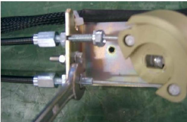
图 5 松开拉线组件上靠近凸轮侧的螺母
