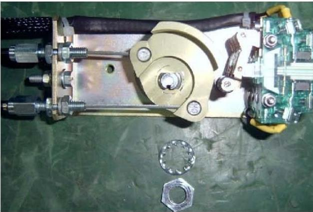
图 3 拆下锁组件上的小螺母及垫圈
