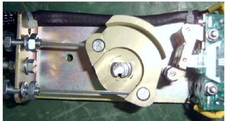
图 22 将联锁凸轮装入锁组件
